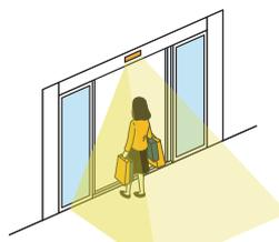
4 通行者を検知しない状態になると、ドアは閉じ再びタッチエリア検知状態に戻ります。
